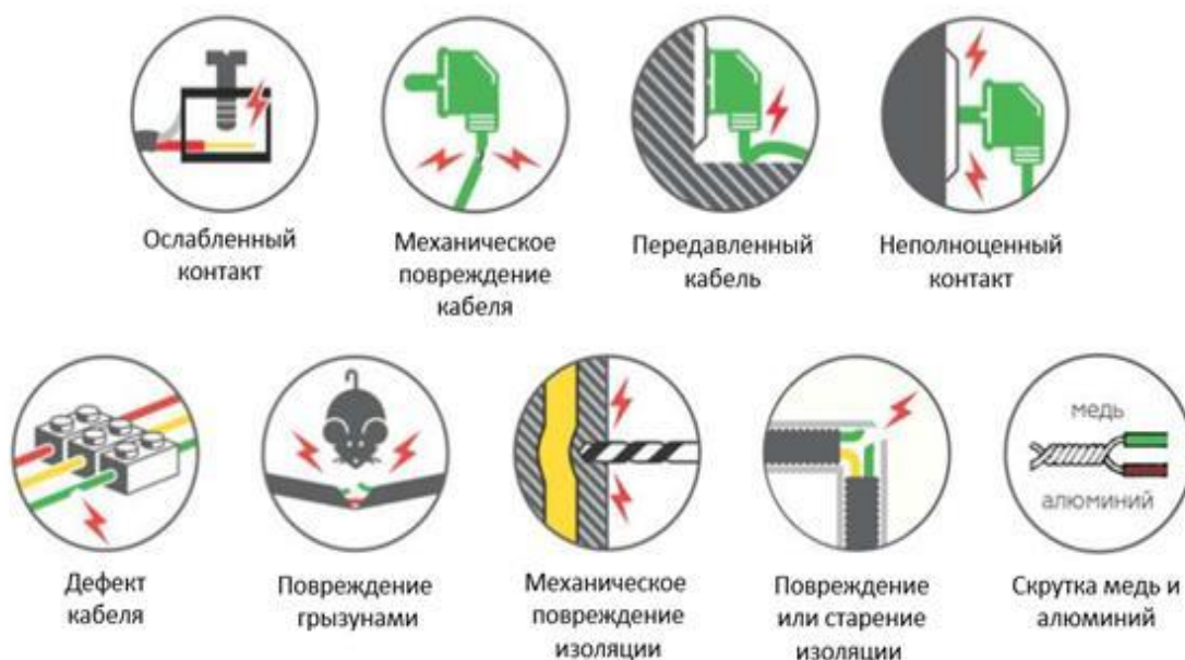
Рисунок 6. Возможные причины искрения в электропроводке
