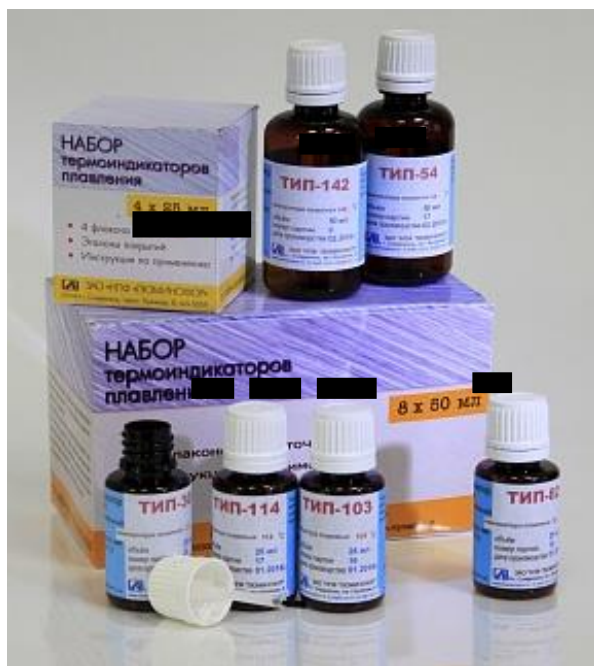
Рисунок 14. Пример исполнения термоиндикаторных красок
